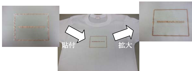
(注) Tシャツ上のアンテナ回路 (L/S=0.1/0.1mm)
