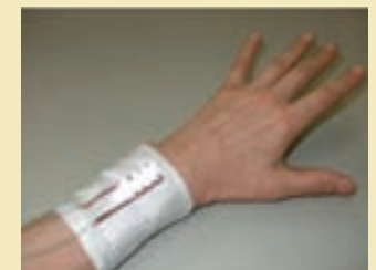
布上に金属回路を形成して、LEDを点灯させた例
